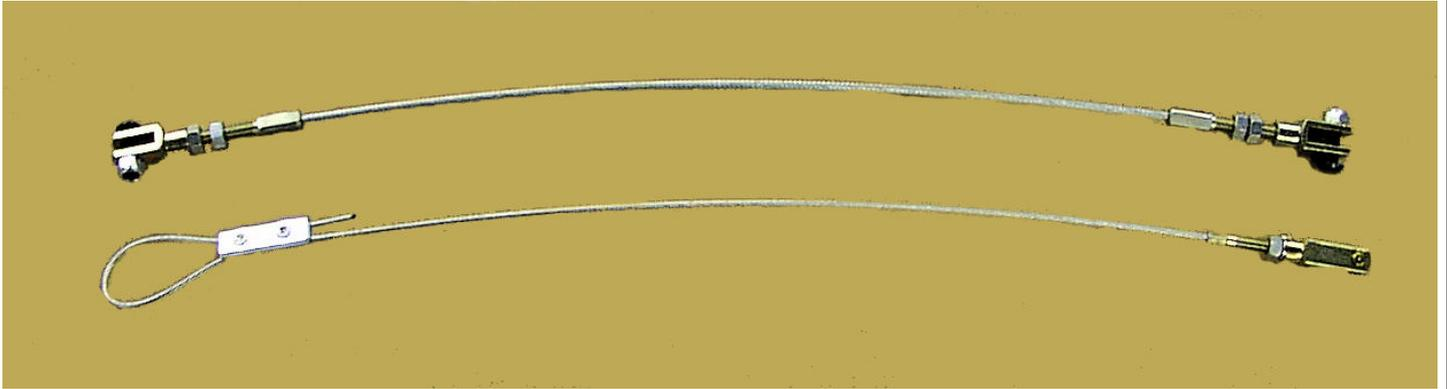
**La commande de freinage doit être isolée du châssis et montrer la double commande**
